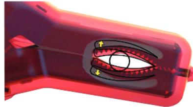
Megger-Klemme wird mit dem genormten Prüffinger gemäß IEC-Norm auf Kriech- und Luftstrecken geprüft.
